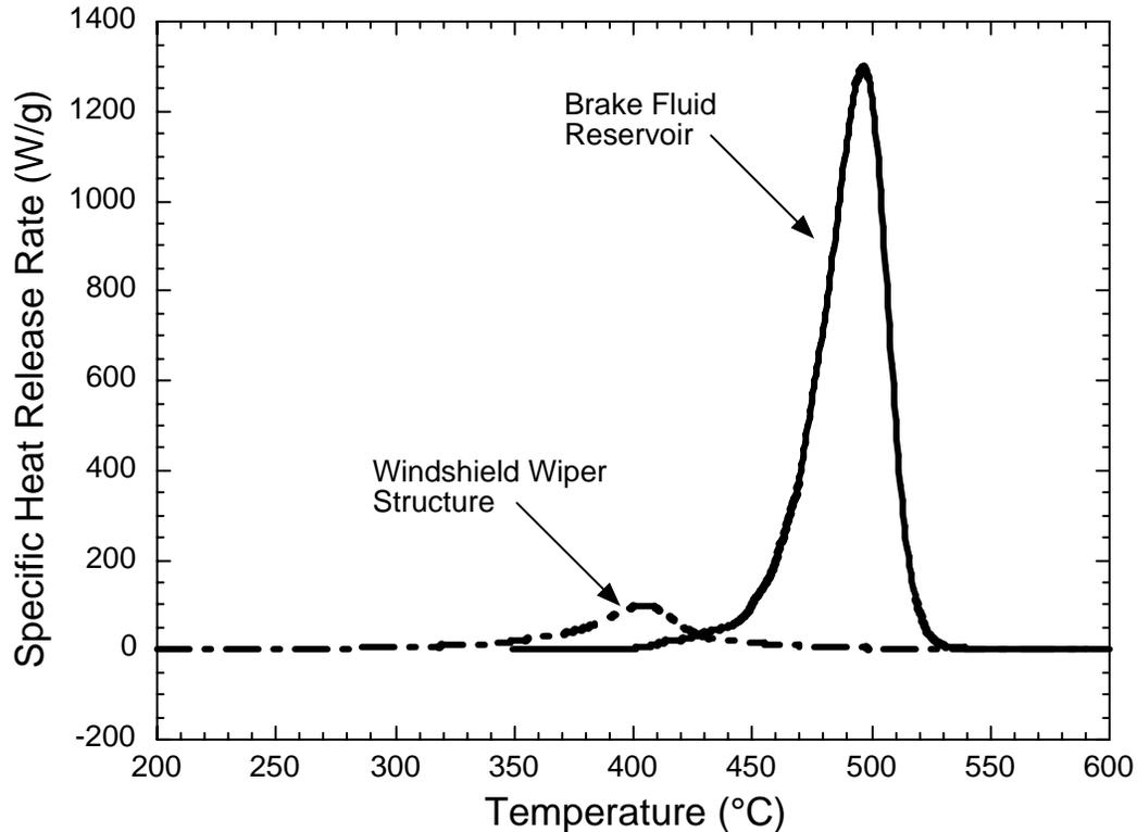
FIGURE 5. PCFC DATA FOR WINDSHIELD WIPER STRUCTURE AND BRAKE FLUID RESERVOIR.
